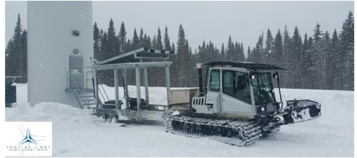
Figure 16 : Dispositif de protection contre les chutes de glace remorqué par un véhicule à chenilles
