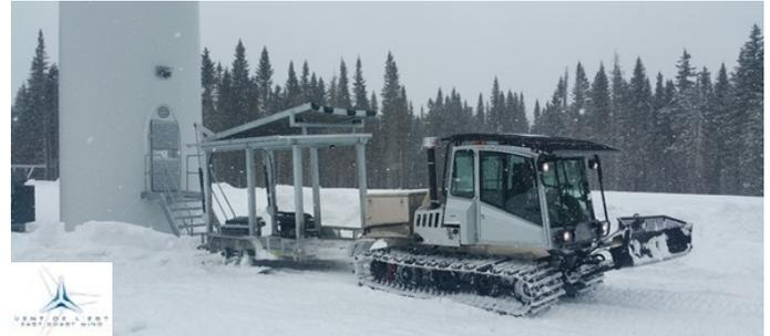
Figure 16 : Dispositif de protection contre les chutes de glace remorqué par un véhicule à chenilles
