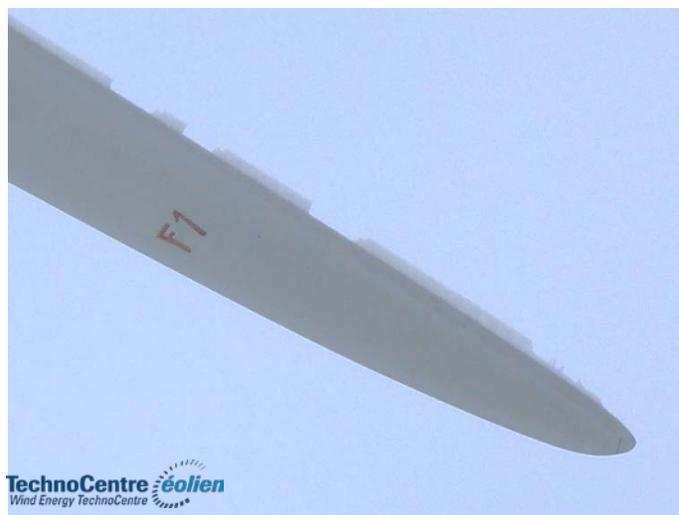
Figure 5 : Exemple de givre blanc léger sur une pale d'éolienne
