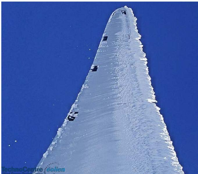
Figure 6 : Accumulation importante de givre blanc sur une pale d'éolienne
